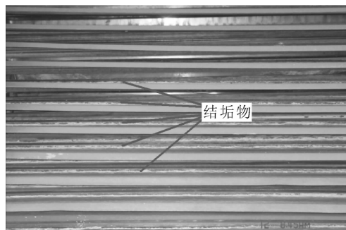
图 10 不锈钢防水栅栏轻微结垢
